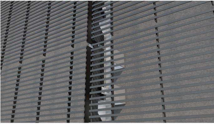
Les panneaux de la façade sont montés sur la structure secondaire grâce aux éléments de fixations découpés dans les supports de grille des panneaux. Ce système permet une grande simplicité et rapidité de montage.
